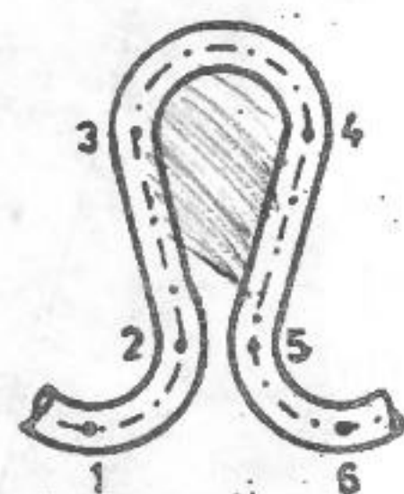
Fig. 4.3. Elementele unui ochi de tricot simplu
